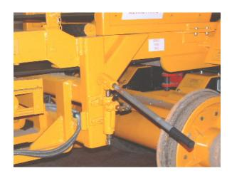
ONCE THE BELT IS POSITIONED DIRECTLY BEHIND THE SUPERBOSS IT MUST BE FOLDED UP AND LOCKED IN POSITION WITH THE SLEW LOCKS AND THE CONVEYOR RETAINING BAR.
