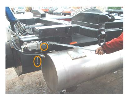
RAISE THE RAIL GEAR UNTIL THE DRIVE TRUMPET IS NO LONGER IN CONTACT WITH THE ROAD WHEELS. THE WHEELS CAN NOW ROLL FREELY.
